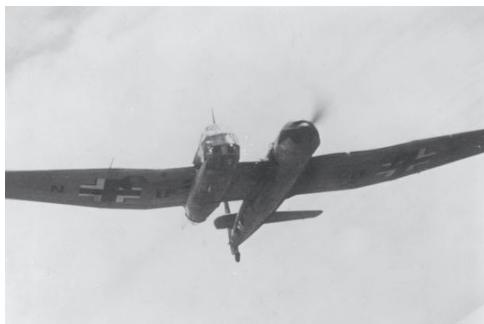
Fig. 4: The asymmetric bomber Blohm & Voss BV 141 in 1942. Bundesarchiv, Blohm & Voss BV 14. (2020), [https://de.wikipedia.org/wiki/Blohm\\_%26\\_Voss\\_BV\\_141#/media/Datei:Bundesarchiv\\_Bild\\_183-B21073,\\_Aufkl%C3%A4rungsflugzeug\\_Blohm\\_-Vo%C3%9F\\_BV\\_141.jpg](https://de.wikipedia.org/wiki/Blohm_%26_Voss_BV_141#/media/Datei:Bundesarchiv_Bild_183-B21073,_Aufkl%C3%A4rungsflugzeug_Blohm_-Vo%C3%9F_BV_141.jpg), access: March 20, 2021, 03:00pm.
